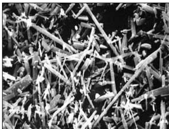
Рис. 4. Морфология игольчатого волластонита 1700X [73].
